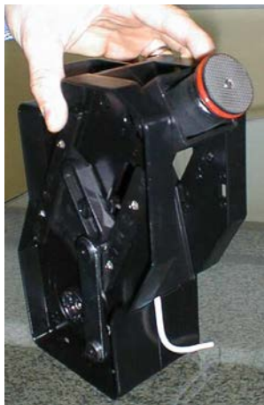
Повернуть верхний фильтр вверх, снять его и промыть горячей водой, удаляя с него кофе
